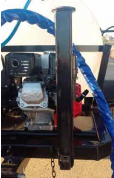
Lanza de tiro retráctil facilita el transporte (ej. Camioneta) y guardado del equipo. Pata de apoyo que luego se transforma en protector de motor.
