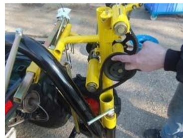
Tire de la bobinadora de la bicicleta y la tensión de la correa mediante la fijación de la barra de apoyo desde el brazo de la rueda a la devanadora amarilla y la fijación con el tornillo de tuerca de mariposa.
