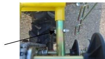
Asegúrese de que el alambre se alimente uniformemente en los carretes. Recuerde lubricar regularmente los embragues y el mecanismo de alimentación de alambre. Si se rompe el tornillo de corte de plástico blanco, compruebe por qué se rompió antes de reemplazarlo; No utilice un perno de acero.
