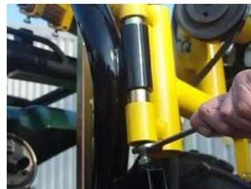
Retire los carretes del poste del carrete y colóquelo en los árboles de la devanadora que guían los alambres a través de los ojos guía y que vienen de la parte inferior de los carretes. Coloque los resortes entre los carretes y comprima entre 5-10mm manteniendo en posición con los embragues. Al tensar los resortes entre los carretes se producirán hilos sueltos y bucles en los carretes
