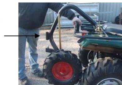
Una vez alcanzada la posición deseada, asegure el bastidor con las placas de sujeción y apriete ligeramente. Trate de sujetar el marco a las partes más fuertes del maletero ATV.
