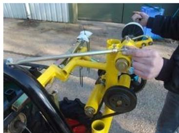
Todos los ajustes están preestablecidos antes de la entrega, pero después de algún uso puede ser necesario ajustar la tensión de la correa. Para ello, mueva el perno de 17 mm del brazo de la rueda hacia arriba para apretar o hacia abajo para aflojar.
