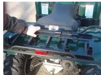
Conecte el brazo de la rueda al bastidor con el pasador grande. La rueda debe sentarse en el neumático trasero fuera de juego. Mueva el conjunto hasta que la rueda esté justo fuera del centro del neumático ATV y el tubo de conexión para el mecanismo de enrollador amarillo esté cerca de la vertical, inclinándose ligeramente hacia la bicicleta
